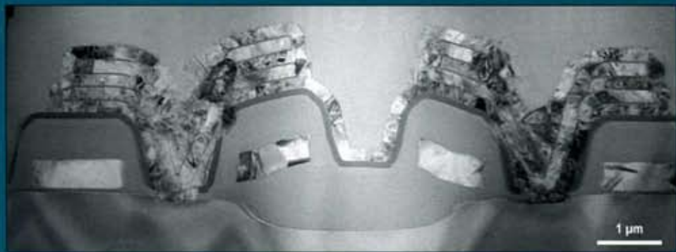
1. ICデバイスの断面TEM観察像
