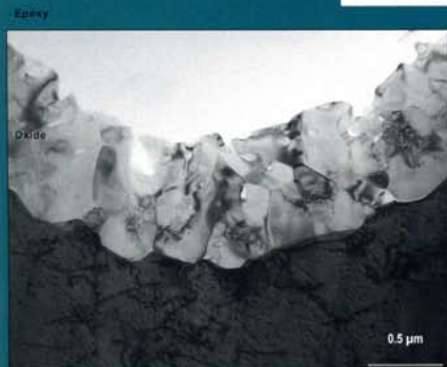
6. 酸化処理を施したFeCrAl合金の断面TEMデジタル像。酸化層のすべてが電子線を透過していることがわかる。
