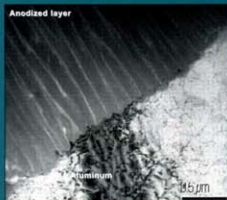
5. 陽極処理をしたAl合金の界面部の断面TEM観察像。
