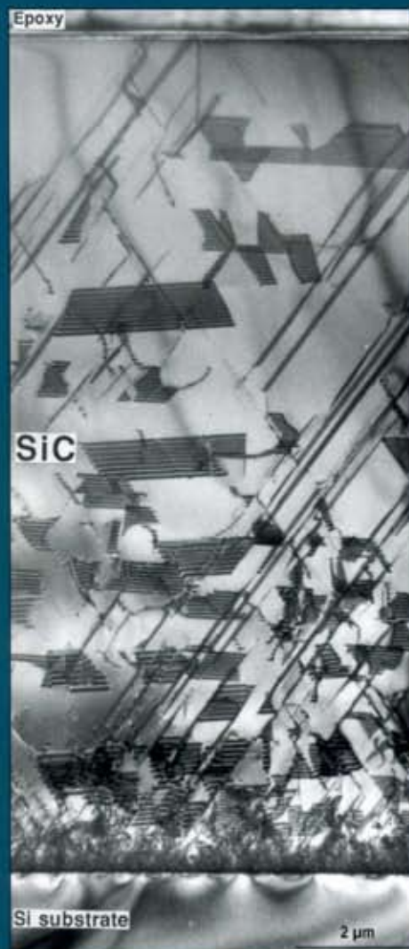
2. Si基板上的の非常に厚いSiCレイヤーの断面TEM観察。
